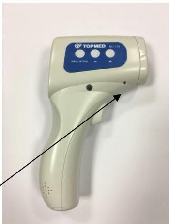
Место нанесения защитной наклейки от несанкционированного доступа
